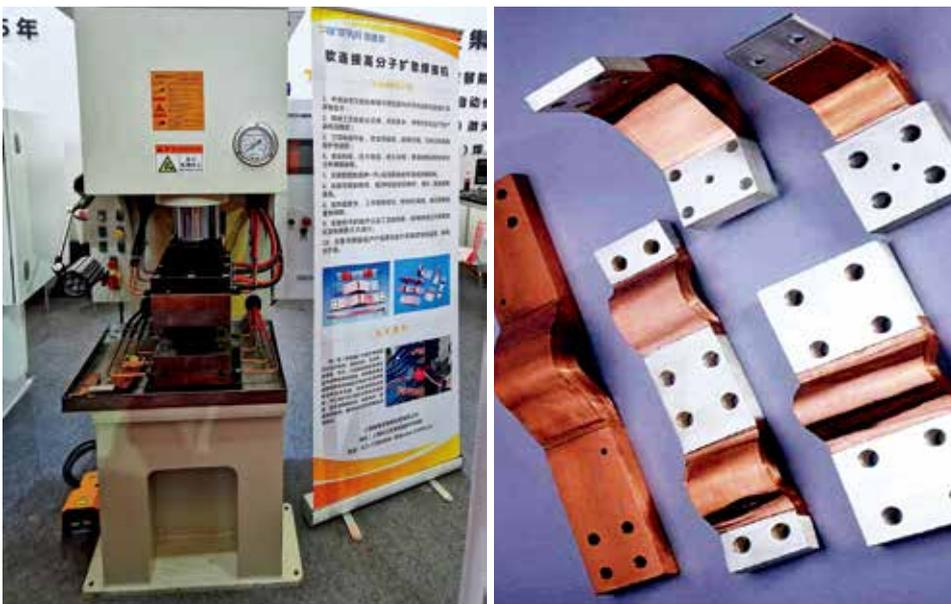
图23 新一代高分子扩散焊机
