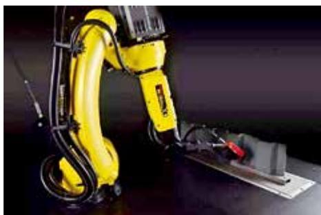
图39 集装箱波纹板智能化焊接系统
