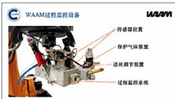
图7 电弧增材制造过程监控装备
