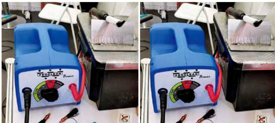
图60 feoclean焊接清洗器
