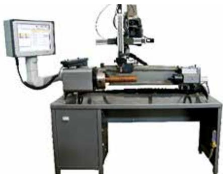
图46 基于TX系统控制器的热丝TIG焊接系统
