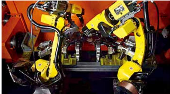
图38 汽车底盘件自动化焊接系统
