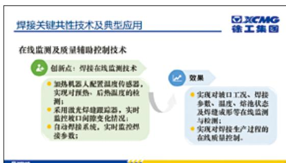
图38 徐工集团的在线监测及质量控制技术
