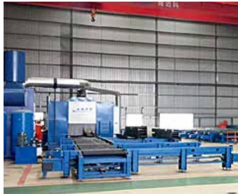
图10 机器人型钢切割生产线
