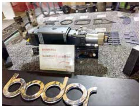
图57 自主研发的自动调高激光头
