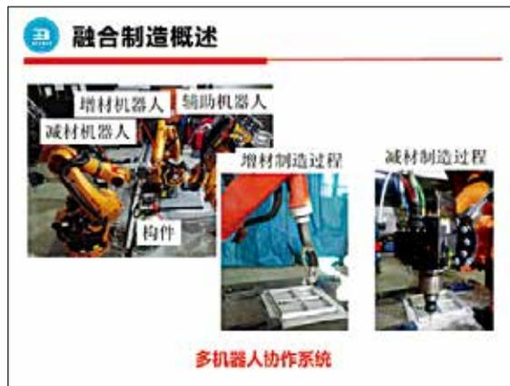
图21 实际的增材制造和等减材制造过程
