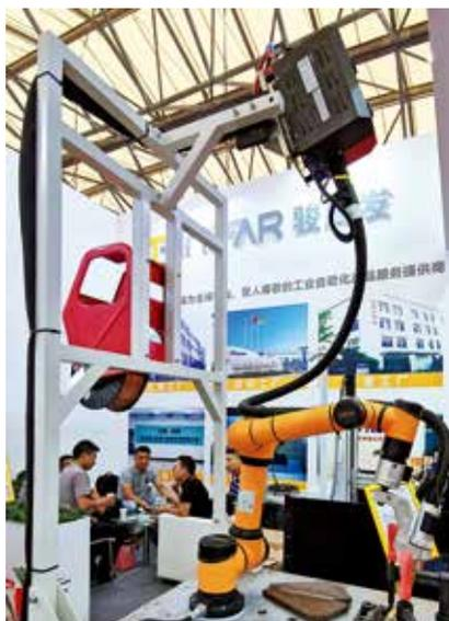
图41 六轴多关节焊接机器人
