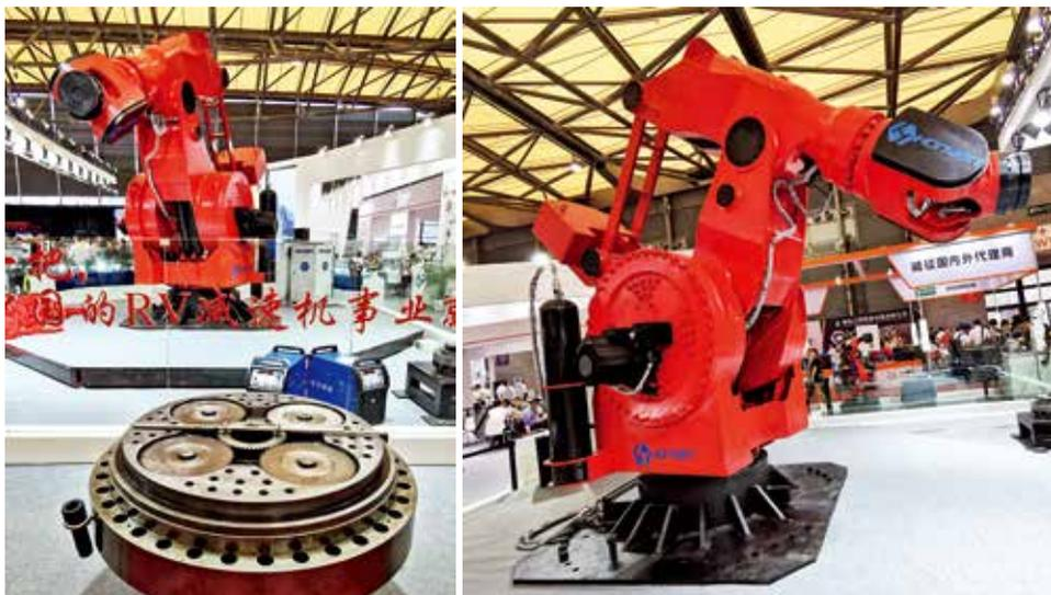
图26 全球最大负载关节式六轴搬运机器人
