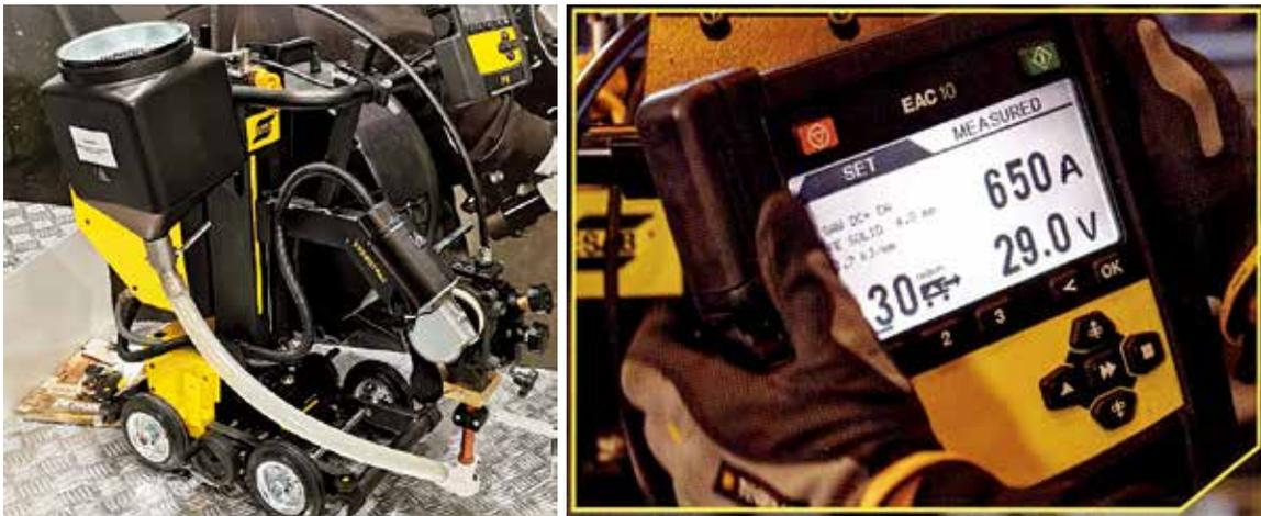
图62 VERSOTRAC EWT 1000焊接小车
