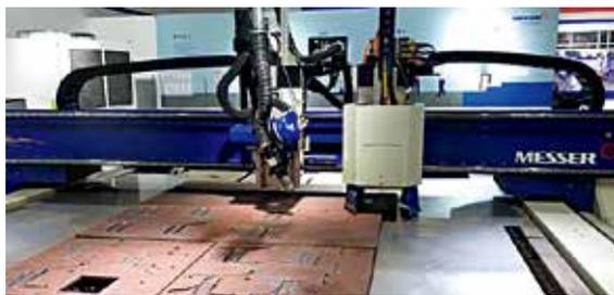
图87 3kW光纤激光与300A精细等离子复合切割机
