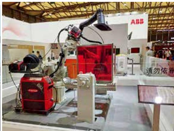
(b) 上海ABB机器人焊接净化一体机
