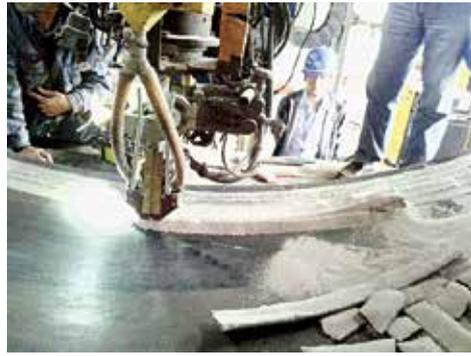
图15 镍基带极埋弧现场焊接图
