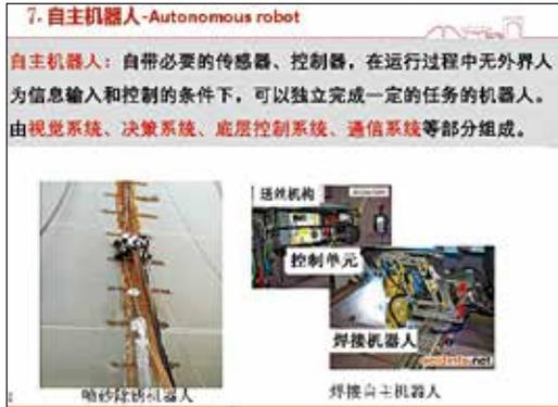
图66 自主焊接机器人
