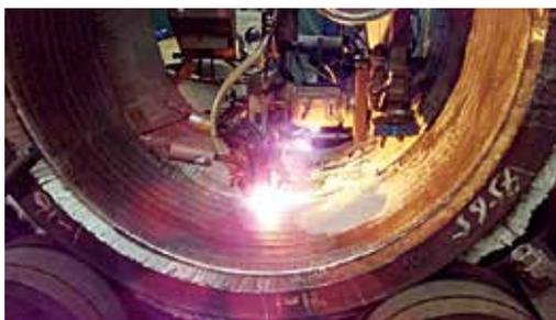
图77 加氢设备用H347LF/SJ15F单层电渣内壁堆焊
