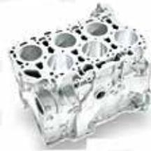
气缸本体的激光3D打印：
