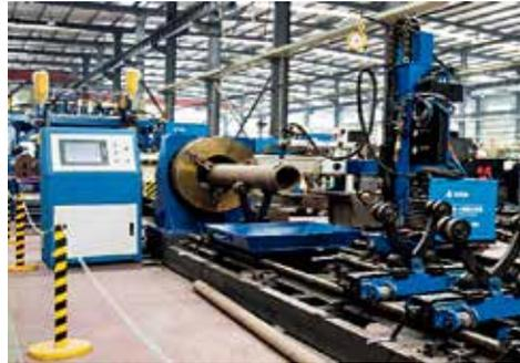
图47 管子相贯线切割机
