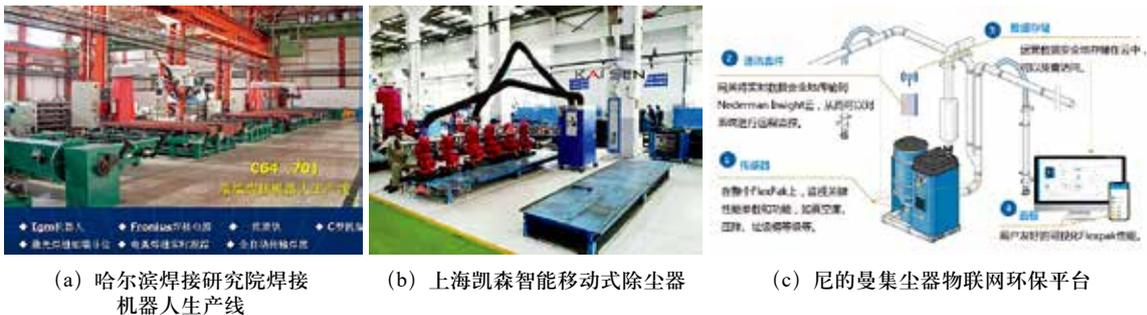
图2 机器人自动化焊接除尘系统和物联网智慧环保平台
