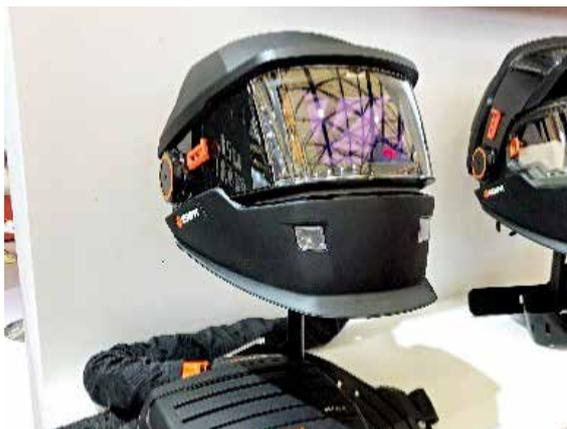
图23 “肯倍”电动送风式焊接面罩
