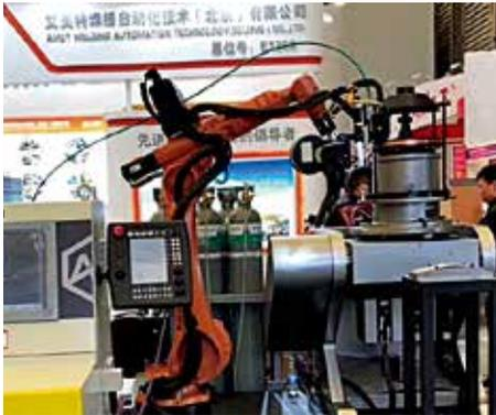
图37 柔性机器人氩弧焊接系统
