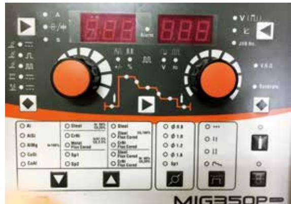
图23 多功能数字波控弧焊逆变电源操作面板
