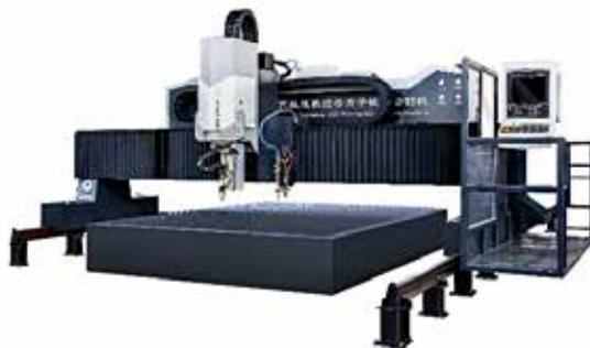
图4 平板坡口切割机
