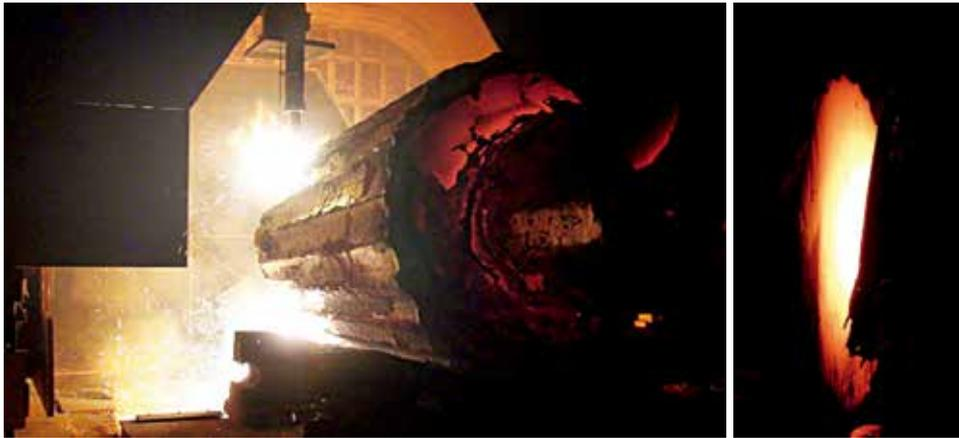
图17 超大厚度钢锭火焰切割设备生产应用
