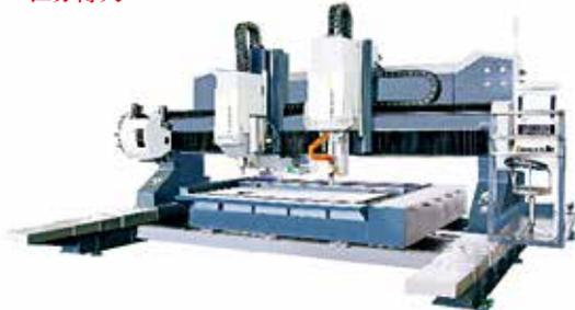
图3 钻切镗铣复合加工中心
