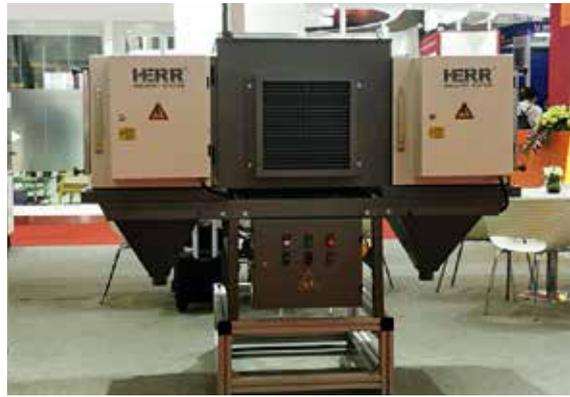
图10 赫尔静电式粉尘过滤器
