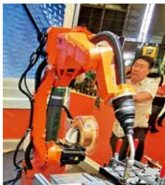
图27 钱江焊接机器人工作站
