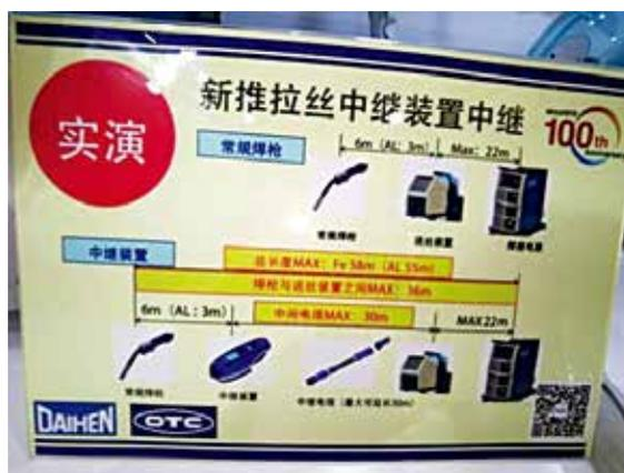
图17 推拉丝中继装置
