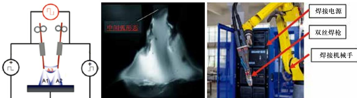
图14 Tri-Arc双丝焊原理、电弧形态及设备外观
