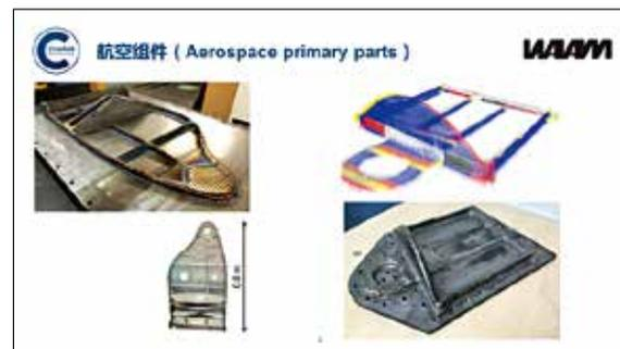
图5 电弧增材制造技术制备的大型航空组件
