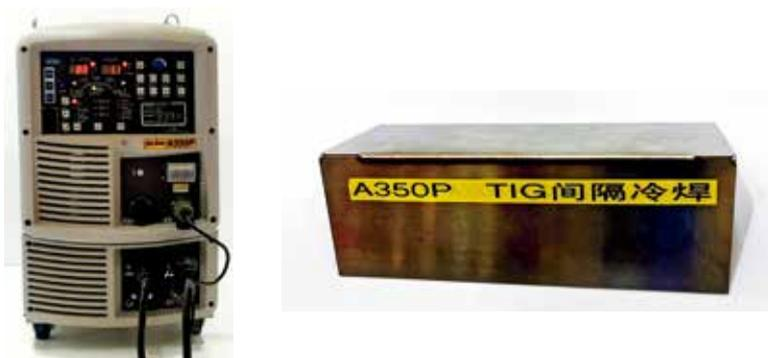
图2 WB-A350P焊机及其TIG间隔冷焊效果
