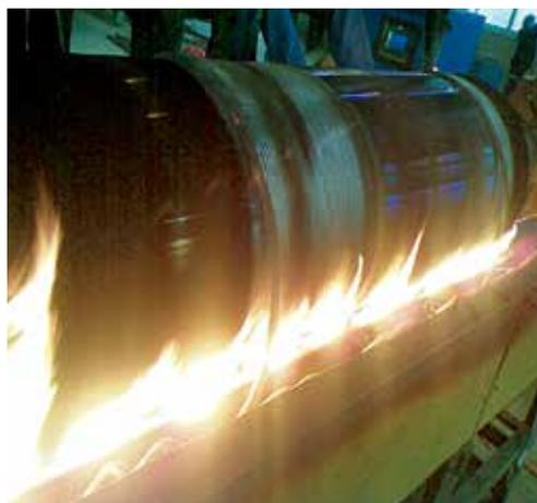
图63 堆焊加工的除鳞夹送辊
