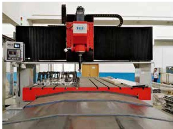
图24 龙门式搅拌摩擦焊机
