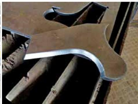
图81 平面坡口切割机与坡口样件
