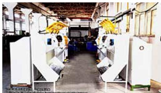
图28 铝合金TIG焊丝表面处理，一体成型设备
