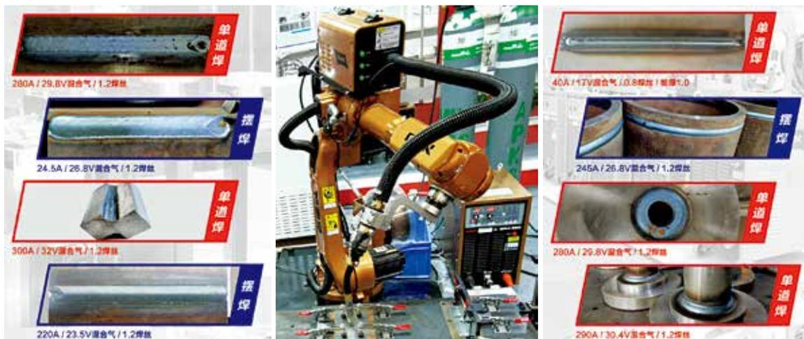
图16 GSK BRH-350全数字焊机在机器人焊接上的应用
