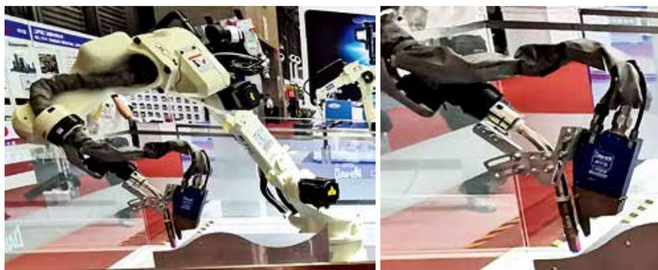
图50 激光跟踪传感器FD-DC在机器人焊接自动化上应用扩展
