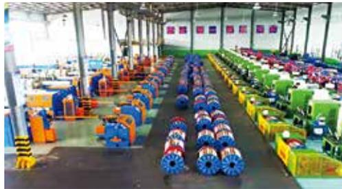
图29 高速镀铜生产线
