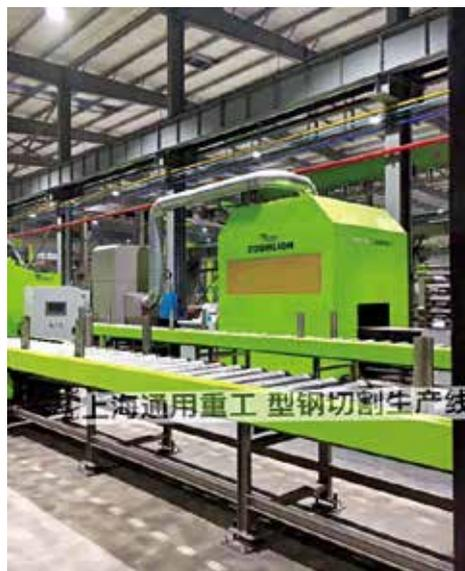
图20 型钢切割生产线
