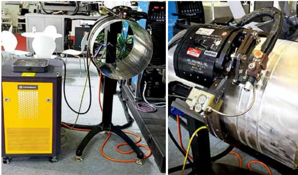
图48 DT数字化控制系统的管道全位置焊接系统
