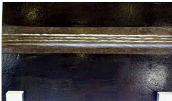
图75 昆山京群GWR-WENi3/GXL-126埋弧横焊焊件
