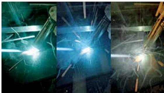
图35 3M G5-01可选色彩的焊接滤光镜
