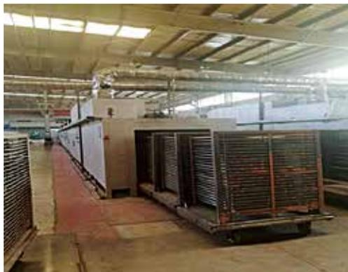
图51 焊条烘烤炉
