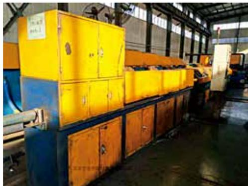
图30 无镀铜核心设备示例
