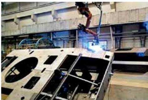
图12 绞股焊丝机器人自动焊接高氮钢
