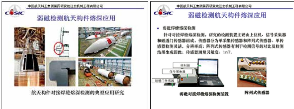
图33 弱磁探测技术在航天构件熔深检测中的应用
