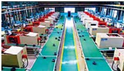
图38 焊丝塑料盘注塑生产系统
