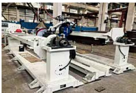
图42 履带梁机器人焊接系统
