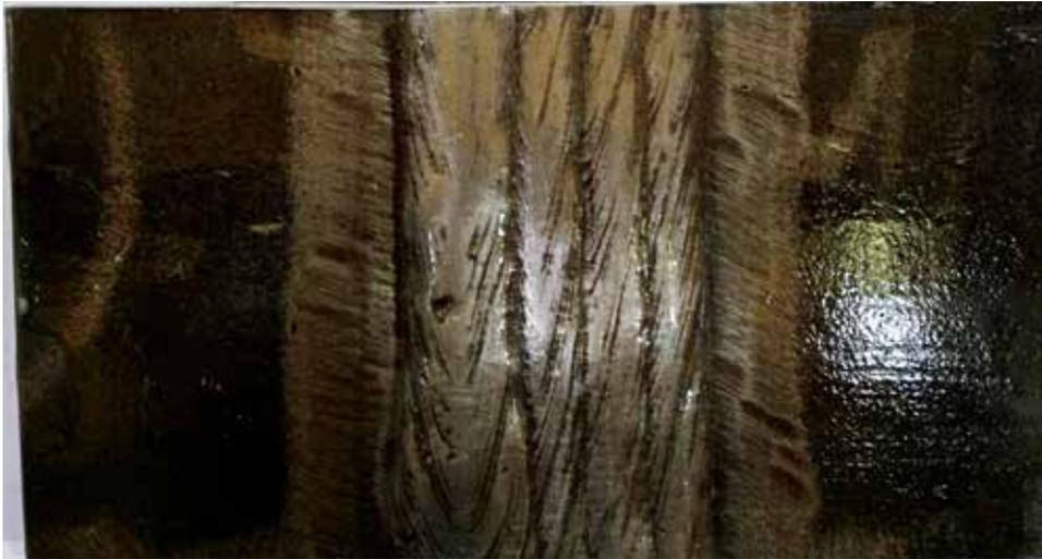
图72 四川西冶1000MPa级水电用XY-S100A/XY-AF100SD埋弧焊材焊件
