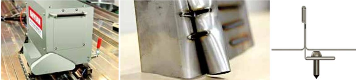
图43 不锈钢金属屋面自动缝焊专机及接头示意图
