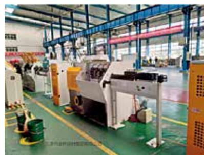
图26 提高工效的直条切断设备
