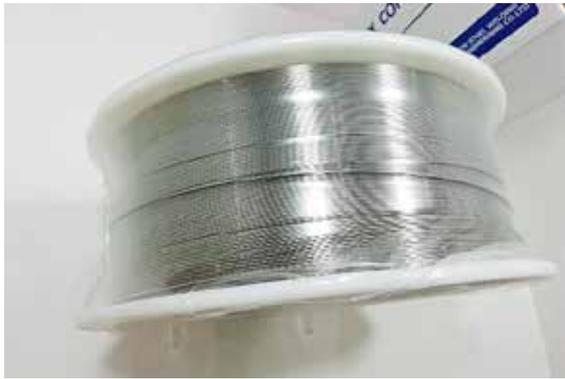
图39 无缝药芯铝焊丝
