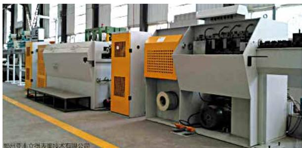
图27 国产铝焊丝精拉机组
