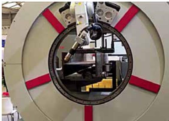
图2 博大机器人360度型钢切割生产线
