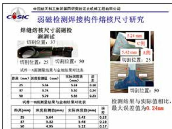
图31 弱磁探测技术应用于熔核尺寸检测
