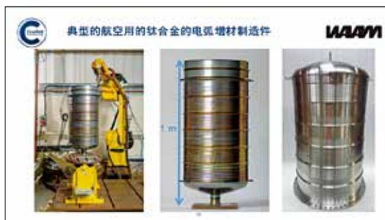
图11 WAAM制备的典型航空用钛合金件
