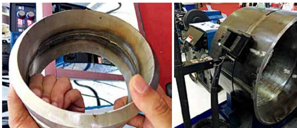
(a) 不锈钢管免背气单面焊双面成型
