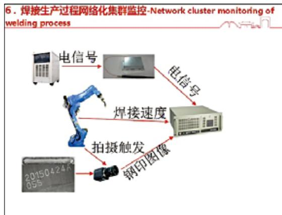
图65 焊接生产过程网络化集群控制
