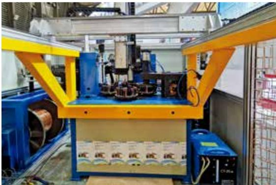
图44 数控全自动金属篮筐式焊丝盘生产成套设备
