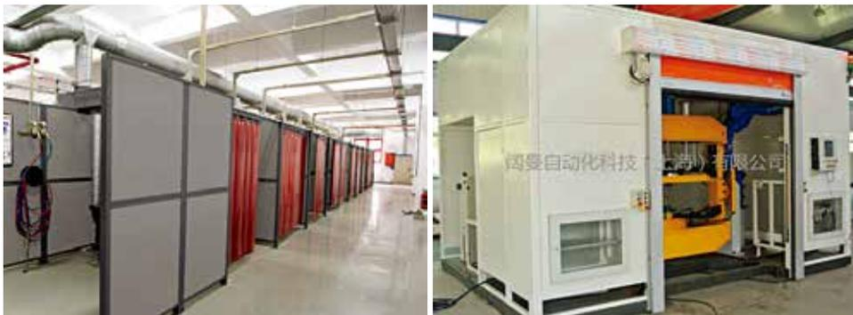
(a) 赫尔模块化焊接防护屏和隔音房
