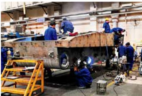
图13 绞股焊丝手工氩弧焊接高氮钢
