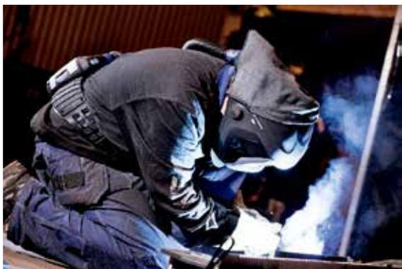
图25 3M可掀起式电动送风焊接面罩
