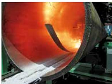
图76 H316LF/SJ15F复合管纵向焊缝单层对接
