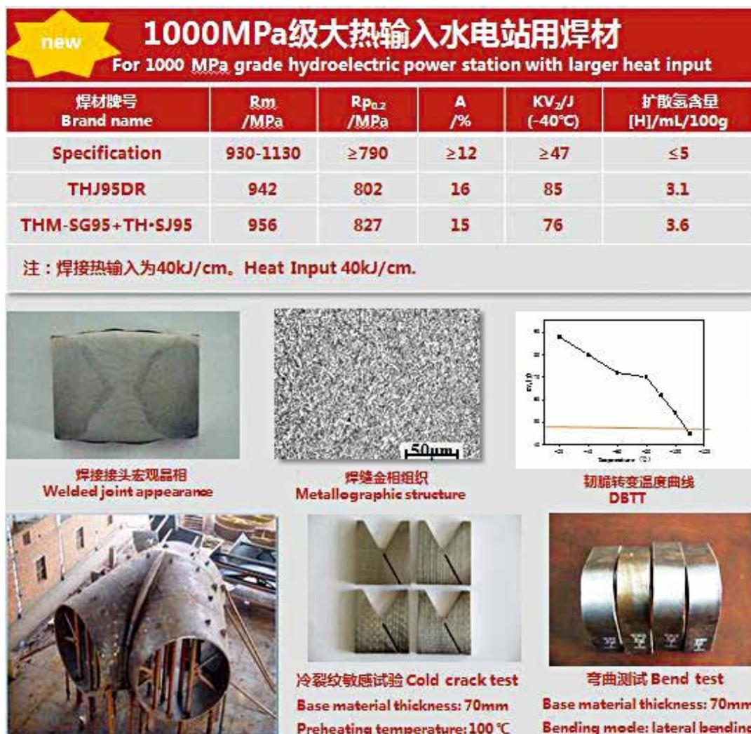
图71 大桥1000MPa级水电用THM-SG95/TH.SJ95埋弧焊材性能
