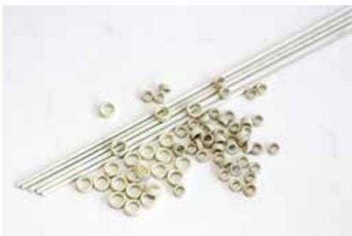
图7 药皮焊条和药皮焊环
