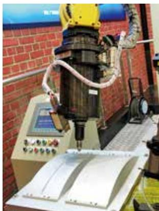
图33 机器人搅拌摩擦焊
