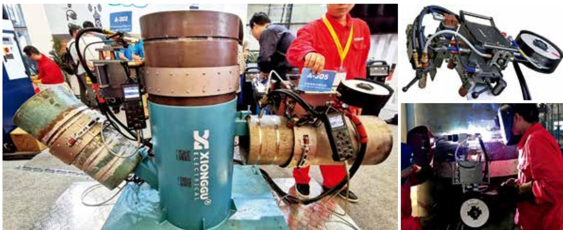
图47 熊谷A-305单焊炬管道自动外焊机施焊场景
