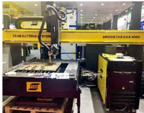
图31 精细等离子坡口切割机
