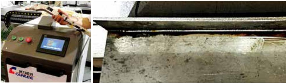
图20 创力手持激光焊接设备及焊接样品
