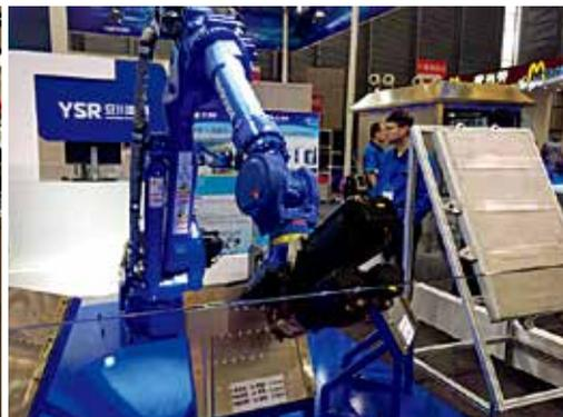
图36 FSSW技术在汽车轻量化等机器人连接技术的应用
