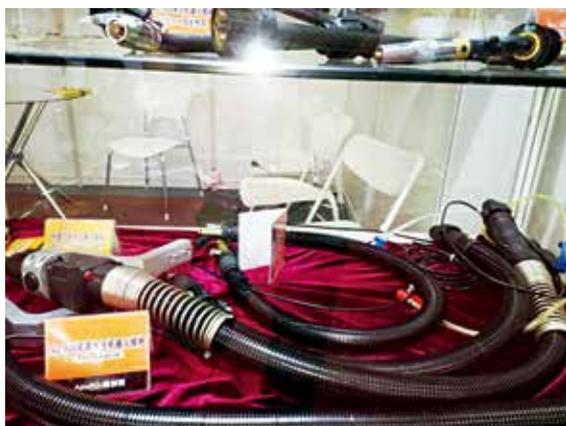
图16 水冷机器人焊枪
